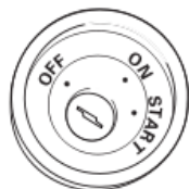
Замок зажигания, на котором не предусмотрено положение АСС
