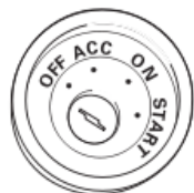
Замок зажигания, на котором предусмотрено положение АСС
